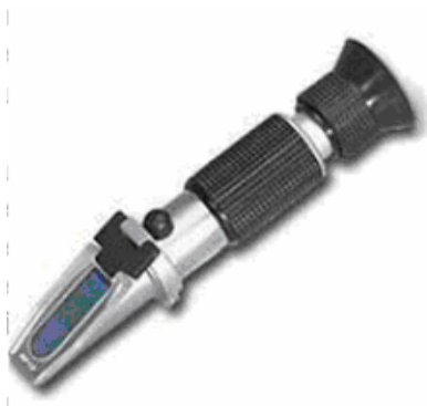
Kuva 10 Refraktometri on käytännössä ainoa tapa mitata mineraaliöljyn pitoisuutta esteriöljyssä.
